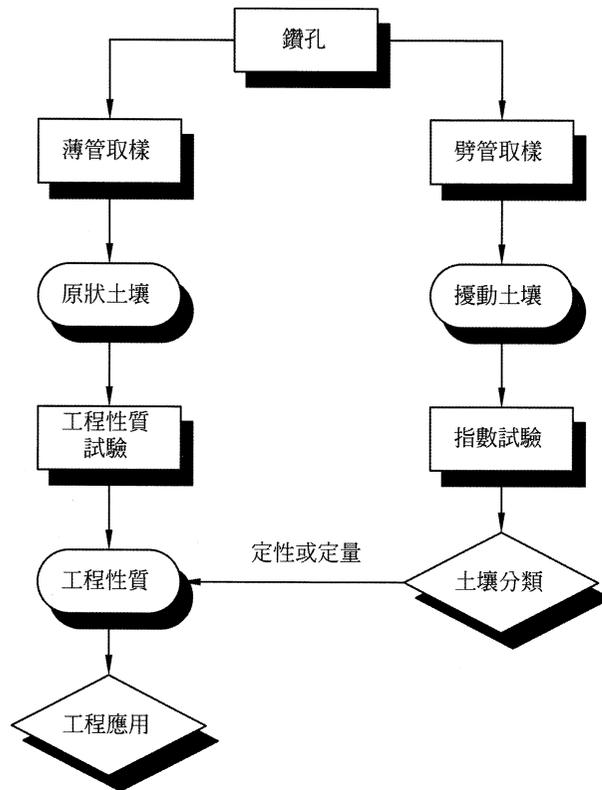
圖(一) 土壤鑽探取樣與試驗的基本流程
